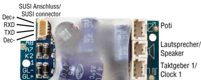
Abbildung 6: eMOTION Decoder Anschlüsse Oberseite
