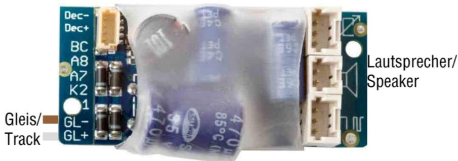
Abbildung 5: Gleis und Lautsprecheranschluss
