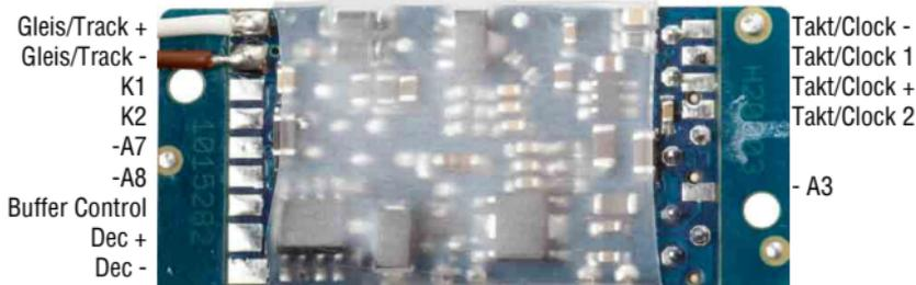
Abbildung 7: eMOTION Decoder Anschlüsse Unterseite
