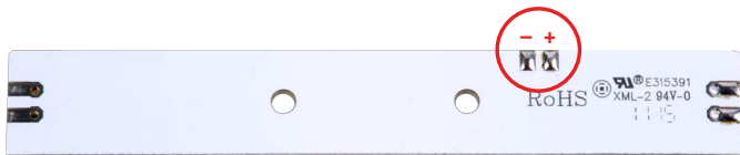
Abbildung 2: Pufferanschluss (Ansicht der Unterseite) Illustration 2: Power buffer hook up (Bottom side view)
